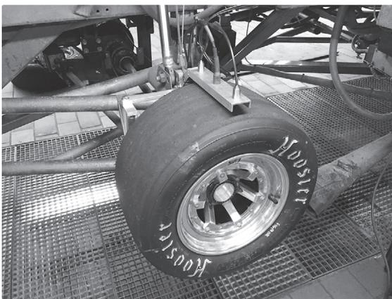
Formula Student Reifen mit eigens entwickelter Temperature Messeinrichtung am MoReLab.
