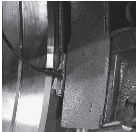
Die Sensorprototypen zwischen der Reibpaarung an einer AM841-Lokomotive
