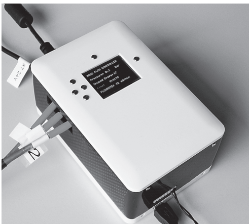
Abbildung 1: Mess- und Steuerelektronik für die Dosiereinheit.
