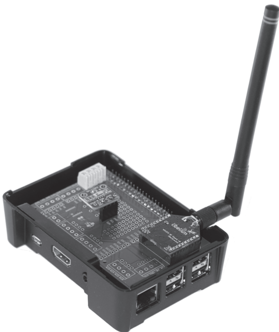
Hardware: RaspberryPi 2 mit eigens entwickeltem Shield und mit LoRa-Modul
