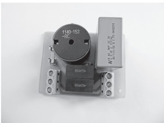
Filterprototyp vor dem Einbau in das Gehäuse
