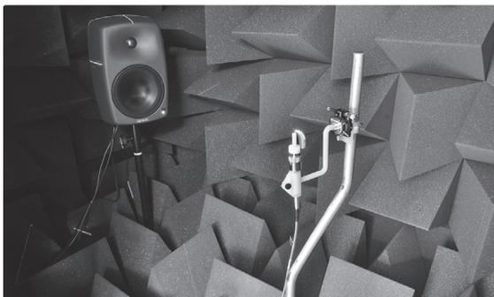
Messaufbau im reflexionsarmen Raum mit einem Behind-The-Ear (BTE) Hörgerät.
