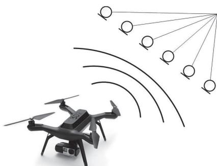
Schematische Darstellung des Systems: Im Vordergrund eine Geräuschquelle, im Hintergrund das genutzte Array
