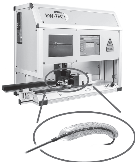
Laser Schweissmaschine mit Ballonkatheter (Mit freundlicher Genehmigung der BW-TEC AG und der Rontis AG)
