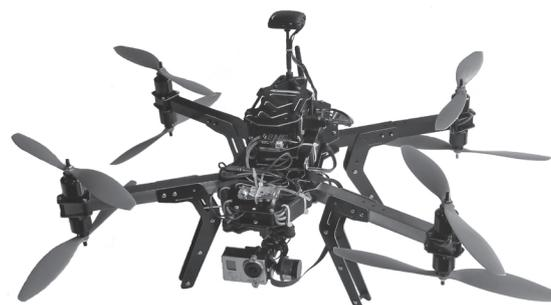
Eingesetzte Drohne: Octokopter X8+ der Firma 3D Robotics
