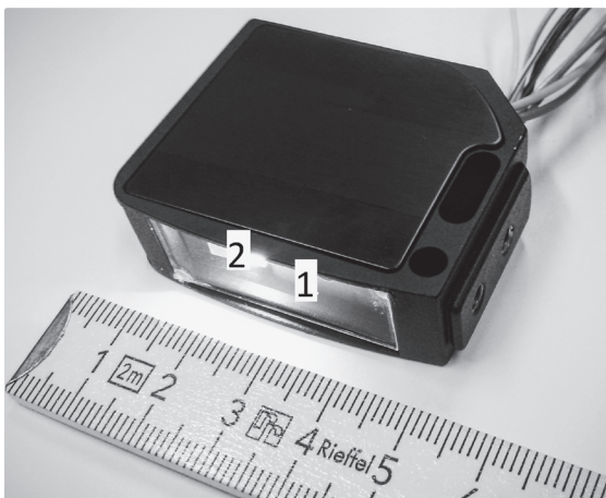
Abbildung 1: Spektrometer (1) mit Weisslichtquelle (2) in Balluff Gehäuse
