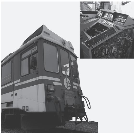
BDeh Triebwagen und Führerpult (ohne Steuerkontroller)
