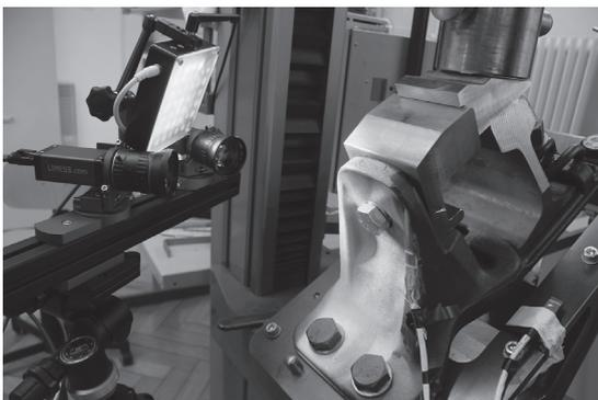
Messaufbau mit Dehnungsmessstreifen und optischem Bildkorrelationssystem
