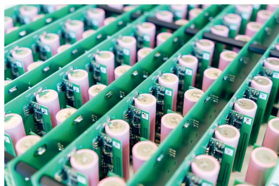
Ausschnitt des Batteriespeichers mit den Batteriezellen und den dazugehörigen Slave-Modulen.
