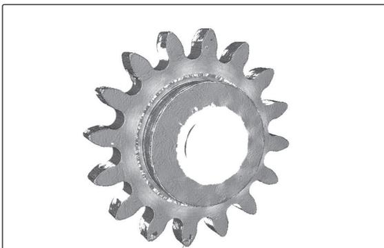
3D-Punktwolke der Achse nach Messung bestehend aus ca. 300'000 Messpunkten.
