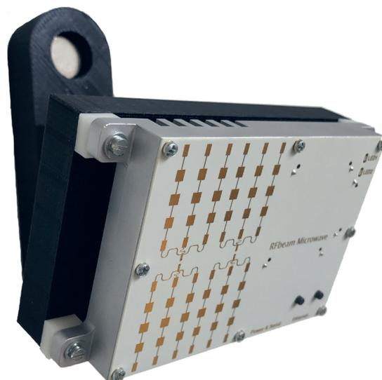
Radar-Sensor mit Montagevorrichtung
