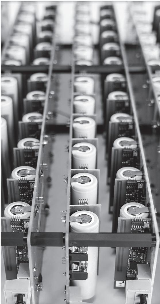
Testsystem mit 120 18650 Lithium Batteriezellen.
