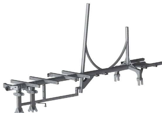
Konstruktionsvorschlag für das Chassis
