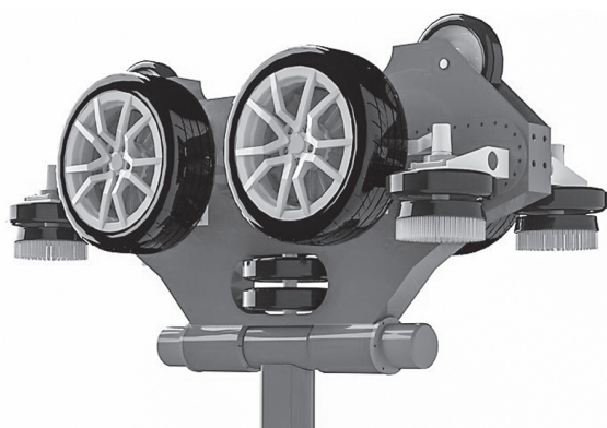
Kompaktes Fahrwerk mit Nabenmotoren, Führungsrollen und Reinigungsbürsten
