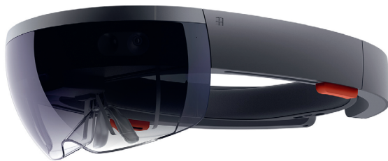
Die Microsoft HoloLens. Diese Brille ermöglicht 3D-Projektionen in der realen Umgebung darzustellen.
