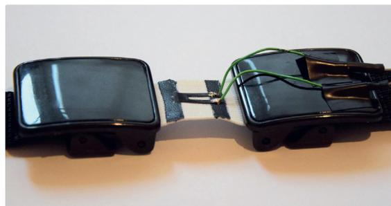
Piezoresistiver Textilsensor, eingespannt zwischen den Schnallen des Brustgurts
