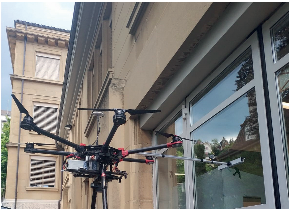
Multikopter zur Reinigung von Fenstern
