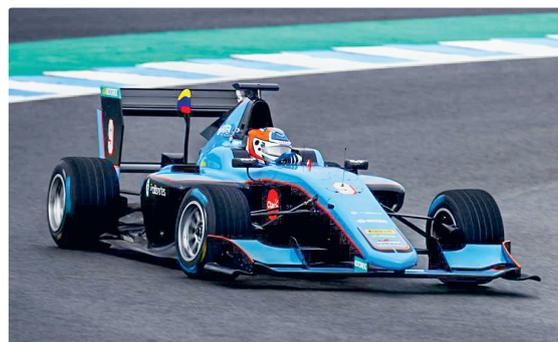
Les GP3 de 2018 ont des moteurs 6 cylindres de 3.4 litres développant 400 CV et pèsent 625 kg avec le pilote.
