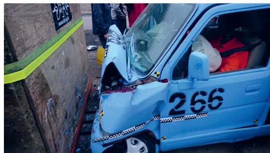
Totalschaden nach Aufprall mit 57 km/h
