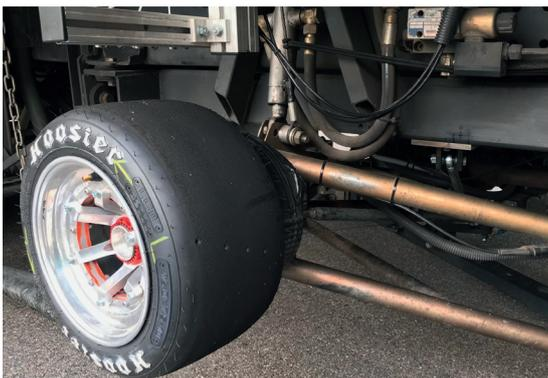
Abb.1: Linkes Messrad am Mobilien Reifen-Versuchslabor
