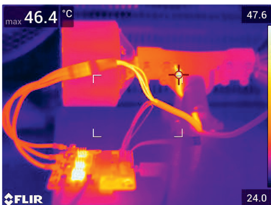
Erste Tests zeigten, dass der maximale Dauerstrom bei der GaN Variante rund 10% höher ist als bei der Silizium Variante
