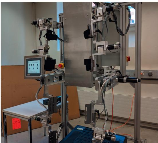
Reharoboter mit Laufband und Bedienpanel.
