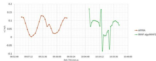
Abb. 2: Fließgeschwindigkeitsmesswerte Vergleichsmessung in Nidau am 16.11.2018
