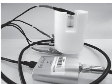
Potentiostat PalmSens EmStat2 mit Messzelle.
