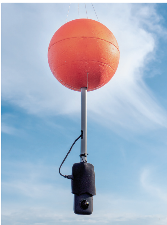
Die Sondenkapsel mit angehängter 360°-Kamera
