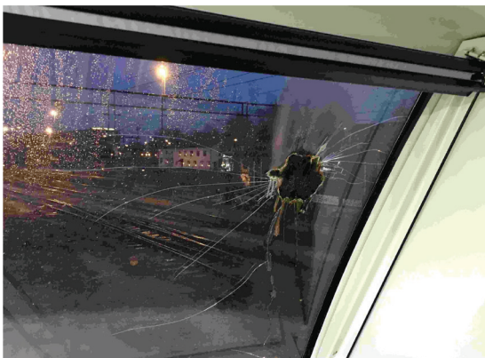
Beschädigung einer Schienenfahrzeugscheibe, welche zum Brand geführt hat.
