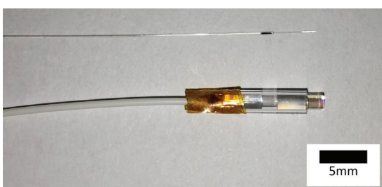
Spezialanfertigte OCT-Sonde (oben) und OCT-Sonde mit dem modularen Glasfaser-Linsen-System (unten).
