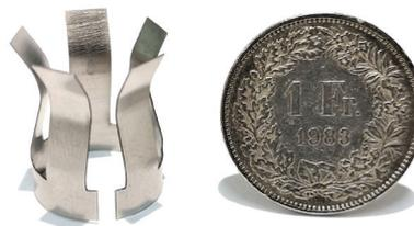
Angefertigte Feder aus Federstahl (Dicke: 0.2mm)
