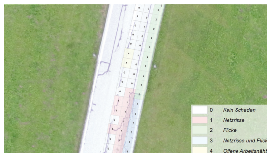
Abbildung 1: Mit Drohne erhobenes Orthofoto der Teststrecke mit Zustandsauswertung der Oberflächenschäden
