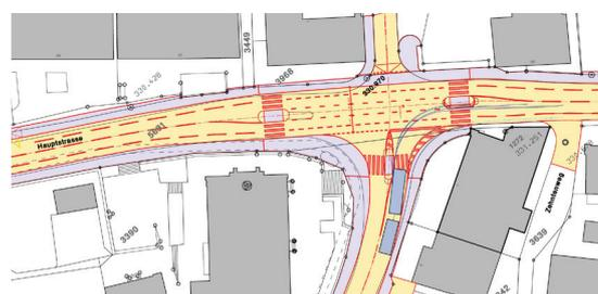
Abbildung 2: Knoten ohne Lichtsignalanlage (Bestvariante)
