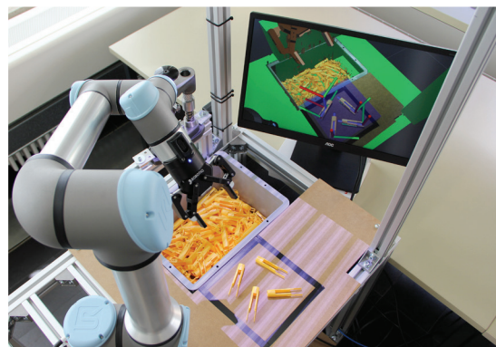
Roboteraufbau mit Visualisierung der 3D-Aufnahme
