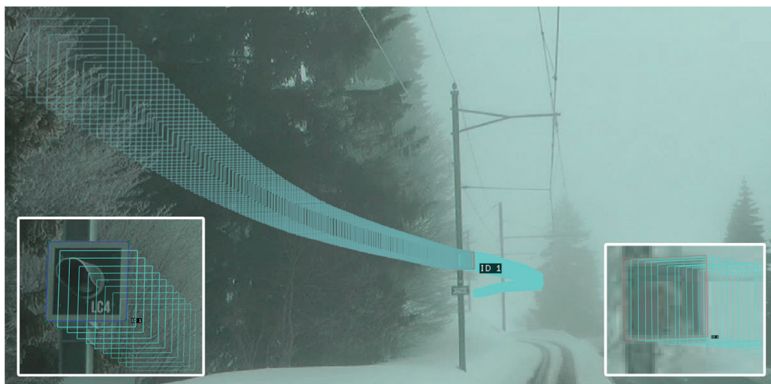
Getracktes blinkendes Bahnsignal bei Nebel. In der Mitte ist das Resultat von 380 Frames sichtbar dargestellt. Links ist das Initialframe, rechts Zoomausschnitt Mitte (nach ca. 130 Frames).
