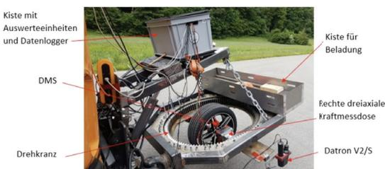
Abbildung 1: Versuchsaufbau
