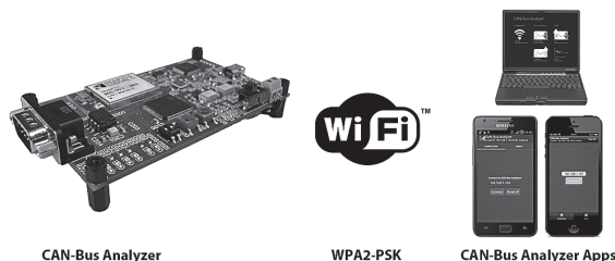
CAN-Bus Analyzer Hardware und Bediengeräte (Android, iOS und Windows) mit den entsprechenden Applikationen
