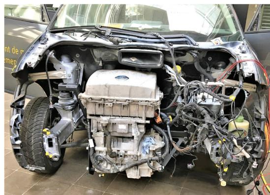
Montierte Antriebseinheit im Fahrzeug
