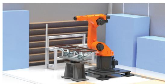
Spannvorrichtung auf dem Drehtisch vor dem Roboter
