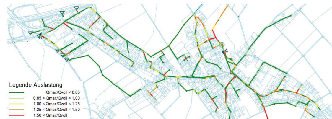
Übersicht Auslastung IST-Zustand
