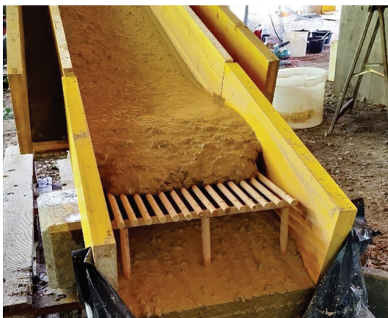
entwässerter Murgang auf dem Modell 1
