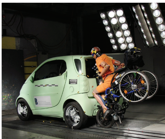
Crash test de collision du fauteuil roulant motorisé contre l'arrière d'un voiture
