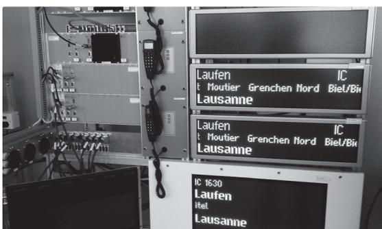
Test-Rack der SBB mit KIS-Rechner und Displays
