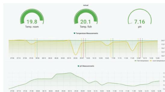
Übersicht von Temperatur und pH Sensoren im Dashboard mit dem aktuellen sowie auch zeitlichen Ablauf der Messdaten.
