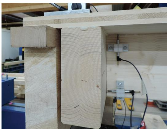
Abb. 1: Querkrafteinleitung der Rippendecke über die Beplankung.
