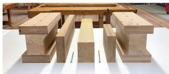
Prüfkörper: schraubpressverklebte Rippenplatten mit hybridem Aufbau
