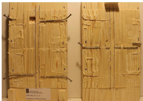
Abbildung 2: Teilgerillte Nägel mit gutmütigem Tragverhalten.
