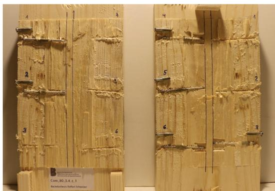
Abbildung 1: Nagelbruch bei gerillten Nägeln.
