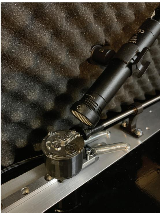
Bild 1: Uhrwerk in der Testbox
