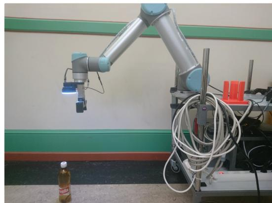
Abbildung 1: Roboter erkennt Trinkflasche
